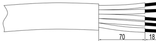
(2) Kabel durch die Kabelverschraubung führen, L1, L2, L3 und N durch Crimpen an den Rohrkabelschuh anschließen (nur mehradrige weiche Litzen müssen an den Rohrkabelschuh gecrimpt werden, einadrige Drähte, dickdrähtige harte Litzen und verzinnzte feindrähtige weiche Litzen dürfen nicht gecrimpt werden);
