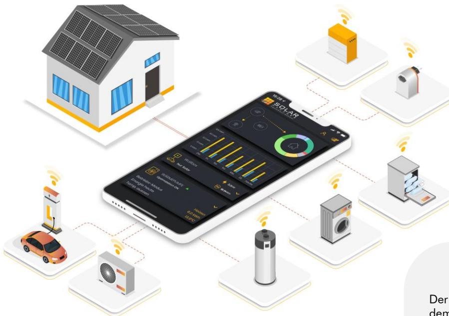
Der Solar Manager besteht aus dem Gateway, der Web Plattform und einer Kundenapplikation. Die Web Plattform erlaubt zudem einen einfachen Zugriff auf sämtliche Konfigurationseinstellungen des Solar Manager. Das Energiemanagementsystem:
